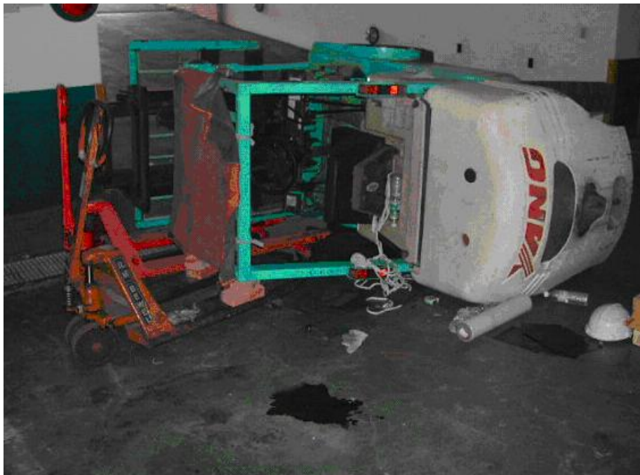
□ 堆高機翻覆之情形
